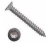
ISO 14586 Blehschrauben Senkkopf, TX25, 5,5x19 mm A2
