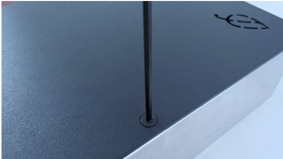
Abbildung 14: Deckel zur Revisionierung öffnen
