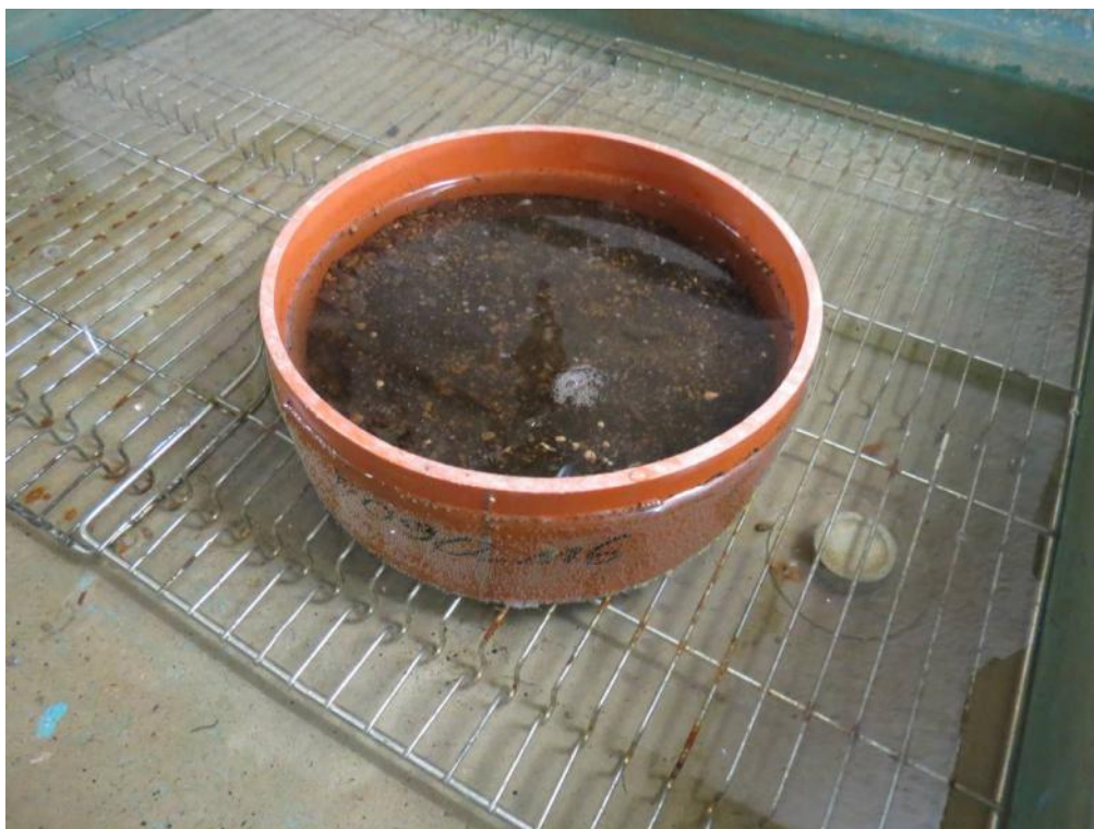
Bild 55: Fotografische Aufnahme des Versuchsaufbaus zur Bestimmung der freien Wassersättigung.
