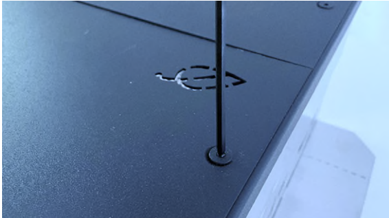
Abbildung 17: Deckel zur Revisionierung öffnen
